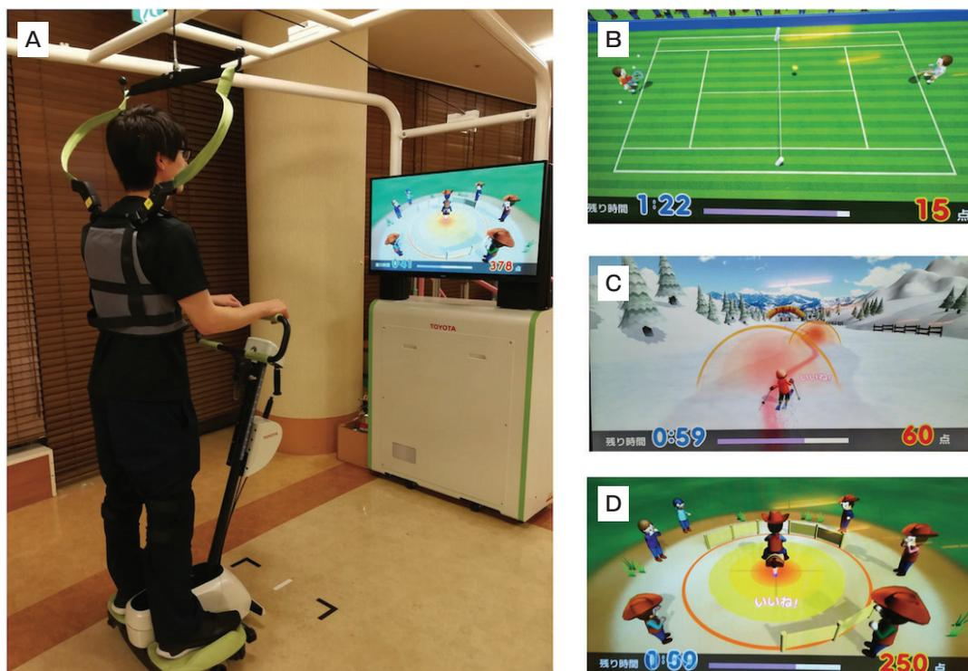
図2 バランス練習アシストロボット(BEAR)
