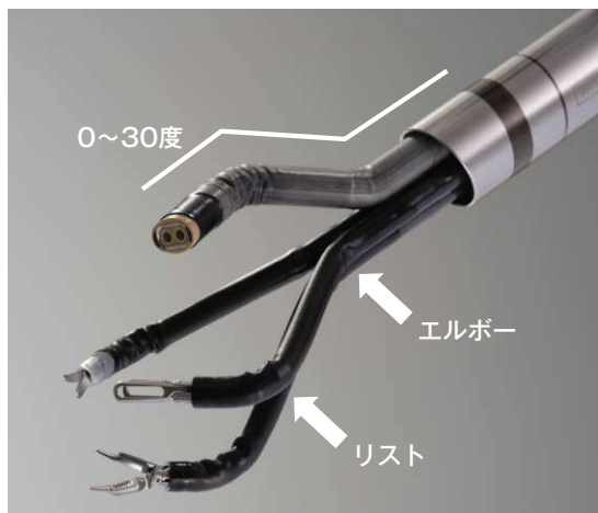
図2 da Vinci SP カメラとインストゥルメント (Intuitive Surgical, Inc. より提供)
